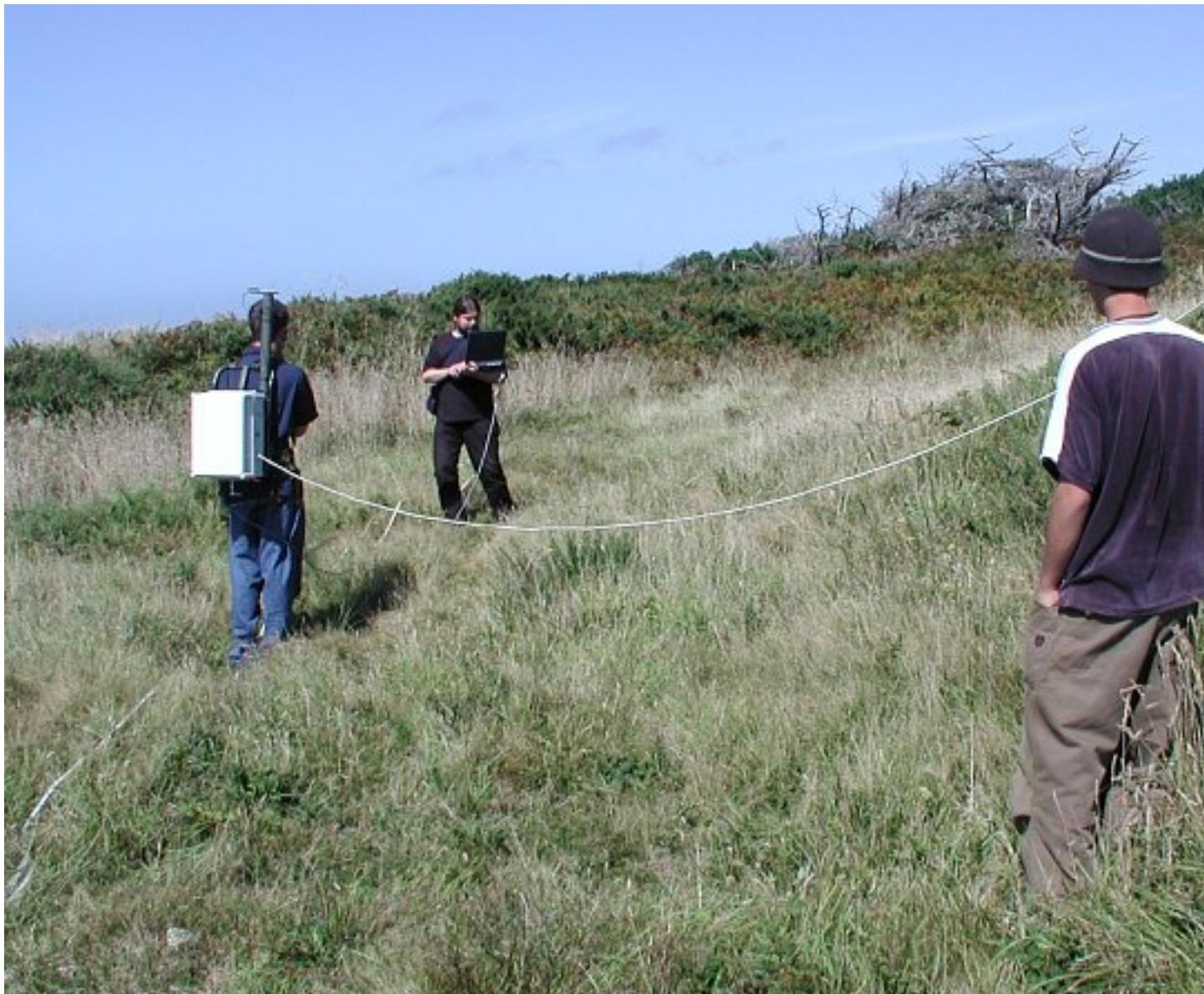
Obrázek 7.1: Ukázka měření v terénu za pomoci terénního zápisníku (směrem od kamery: magnetometr, GPS+elektronika magnetometru, zápisník)
